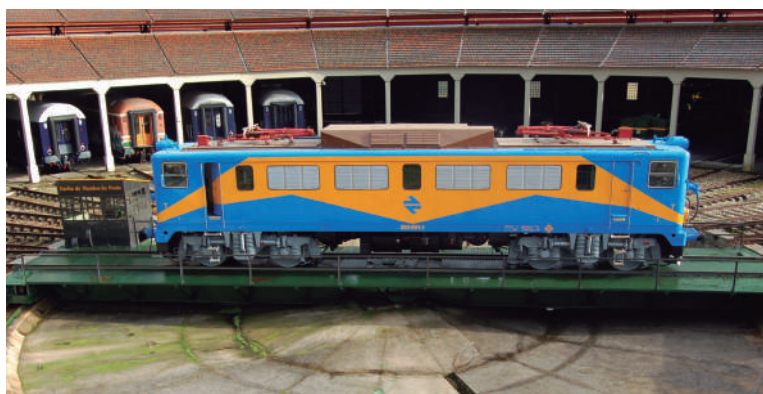
Rotonda ferroviaria para depósito de máquinas
