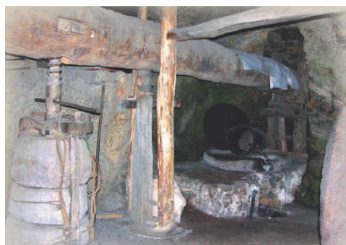
Interior del “Muiño das Farrapas” de Bendilló: Prensa de viga. (Foto del autor).
